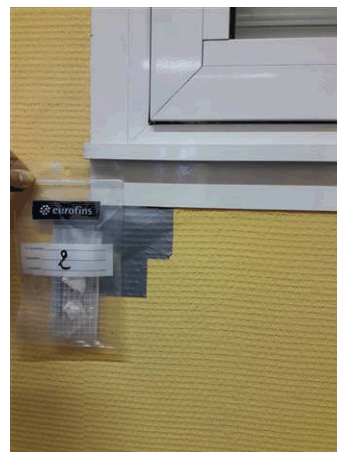
Matériaux : ZPSO-001 Prélèvement : P001; P002; P003; P004; P005; P006; P007; P008 Description : Panneaux plâtre en doublage Localisation : Rez de chaussée; 1er étage; 2ème étage Résultat : Absence d'amiante Quantité :
